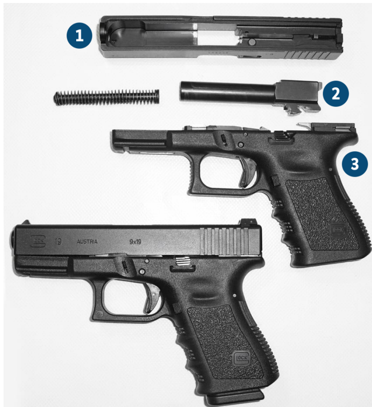
Abbildung 11 halbautomatische Pistole Glock 19, Gesamtwaffe und wesentliche Teile
